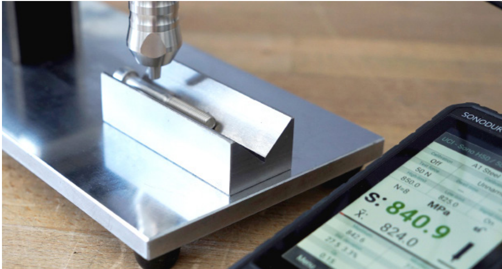
Abb 8. Nachstellen einer Prüfsituation Schraube messen am Schaft
